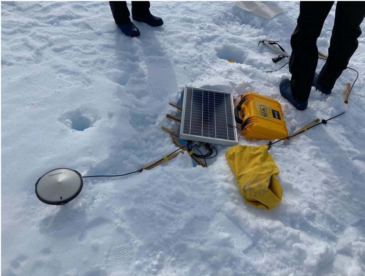
ラングホブデ氷河上に設置されたGNSS測定装置
